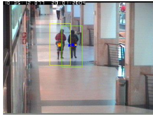
Fig. 7. Efecto del filtro de Kalman ante la pérdida temporal de la detección.
