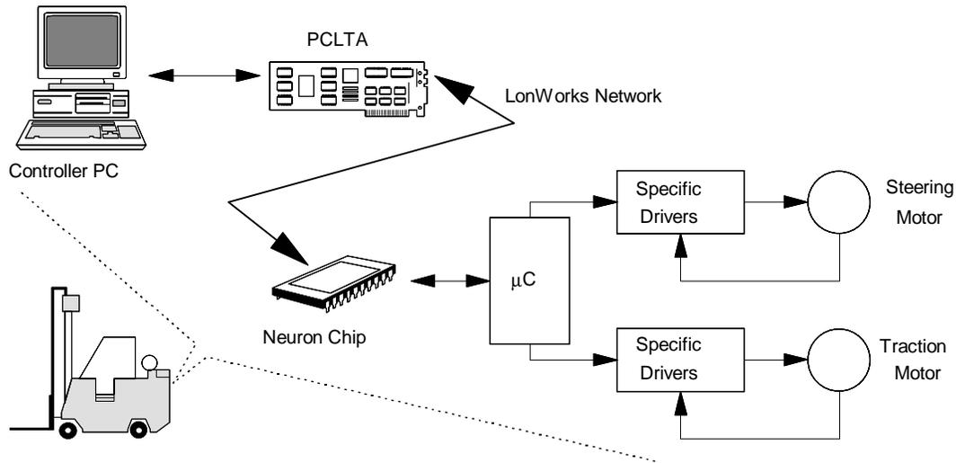
Figure 2.- Industrial Lift Truck: Block Diagram.
